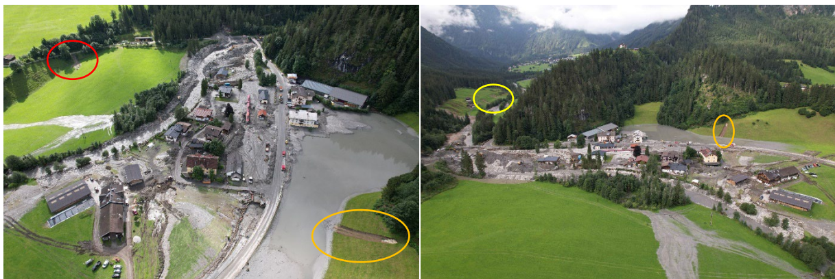
Abb. 14: Der nach drei Murenabgängen aus dem Bräuergraben verwüstete Ortsteil Vorderkrimml in der Gemeinde Wald im Pinzgau (Bundesland Salzburg) mit dem Bahnhof Krimml und einer am Abend des 16. August 2021 abgegangenen Hangmure (dunkelgelbe Umrahmung jeweils in der rechten Bildhälfte der Fotos), einer Böschungsrutschung (rote Umrahmung im linken Foto) sowie einer Reihe von Hangrutschungen im Ortsteil Unterkrimml der Gemeinde Krimml (Bundesland Salzburg) (hellgelbe Umrahmung im rechten Foto) (© Fotos: Militärkommando Salzburg/Bundesministerium für Landesverteidigung; Quelle: Webseite des Bundesministeriums für Landesverteidigung) [1].
