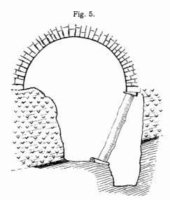
Tektonische Überlagerung von Wechselschiefern durch den mylonitisierten Granitgneis im Ring 23 (Meter 190).
