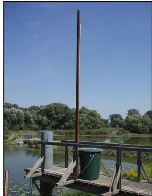
*Foto 6 (links) und 7 (rechts): Messeinrichtung an der Tiertraverse und Schönauer Traverse mit automatischen Wasserprobenehmern und Pegelstation.*
