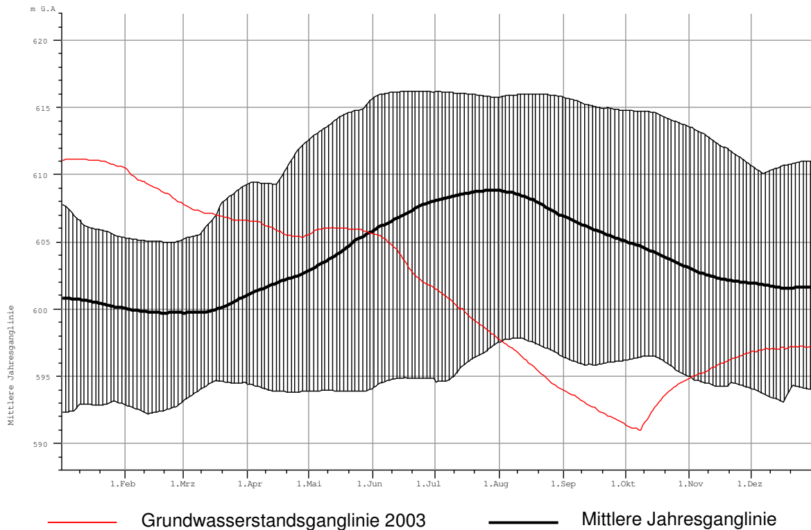
Abbildung 25: Messstelle 332015 Lorüns-Stallehr, BI 60.1.01 im Klostertal, Mittelwerte und Extrema des Grundwasserstands von 1987 bis 2002, Ganglinie 2003
