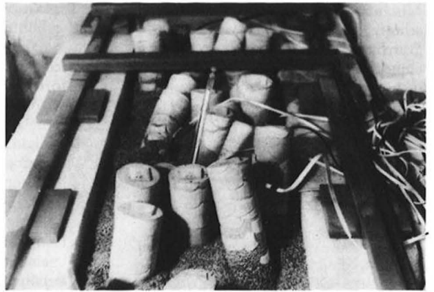
Abb. 34: Frosthebungen gegen Ende des Frostversuches; stark frostgefährdete Prüfkörper; a) Boden I, II + Kalk; Prüffalter 7 Tage b) Versuchsmischungen vor Verdichtung karbonatisiert (7 Tage Luftzutritt bei ausreichendem Wasserangebot); Prüffalter 270 Tage .
