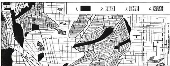
c) Darstellung des tektonischen Zustandes: 1. Gesteine nicht oder nur schwach zerklüftet; 2. Gesteine weitständig zerklüftet, große Klüftkörper; 3. Gesteine stark zerklüftet, Faltungs- bzw. Schieferungsstrukturen; 4. sehr stark zerklüftete Gesteine.
