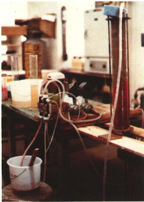
Abb. 4: Injektionseinrichtung (zu Abb. 3) Allmähliches Hochsteigen des von unten eingepreßten Injektionsmittels in der Anfangsphase der Silacsol-Injektion (Rotfärbung des Reaktivs zu Kontrollzwecken).
