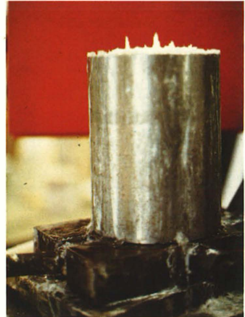
Abb. 7: Herstellung injizierter Prüfkörper nach dem Joosten-Verfahren. Strukturbildung durch spontane Reaktion der Chemikalien oberhalb der Lochplatte des Behälters am Ende der Injektion.
