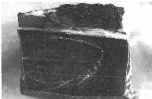
Abb. 4: SLA-8: Poliertes Handstück (Gesamthöhe 5 cm) mit Übergang von der Vererzung (Oben mit hellem Antimonit) zum unveränderten, leicht geschieferten Nebengestein (Kalkglimmerschiefer). Dazwischen sieht man die silifizierte Zone, die durch ihre hellere Färbung und den grusigen Charakter gekennzeichnet ist. Diese Zone geht vom Lettenez im cm-Bereich bis in den dunkelgrauen Kalkglimmerschiefer über.
