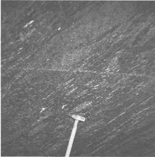
Abb. 7 und 8: Oberer Druckstollen, Station 9320 m: Epidot-Plagioklasgneis- und Prasinitkomponenten in dunklen Biotit-Plagioklasschiefern werden als Metaagglomerathorizonte interpretiert.
