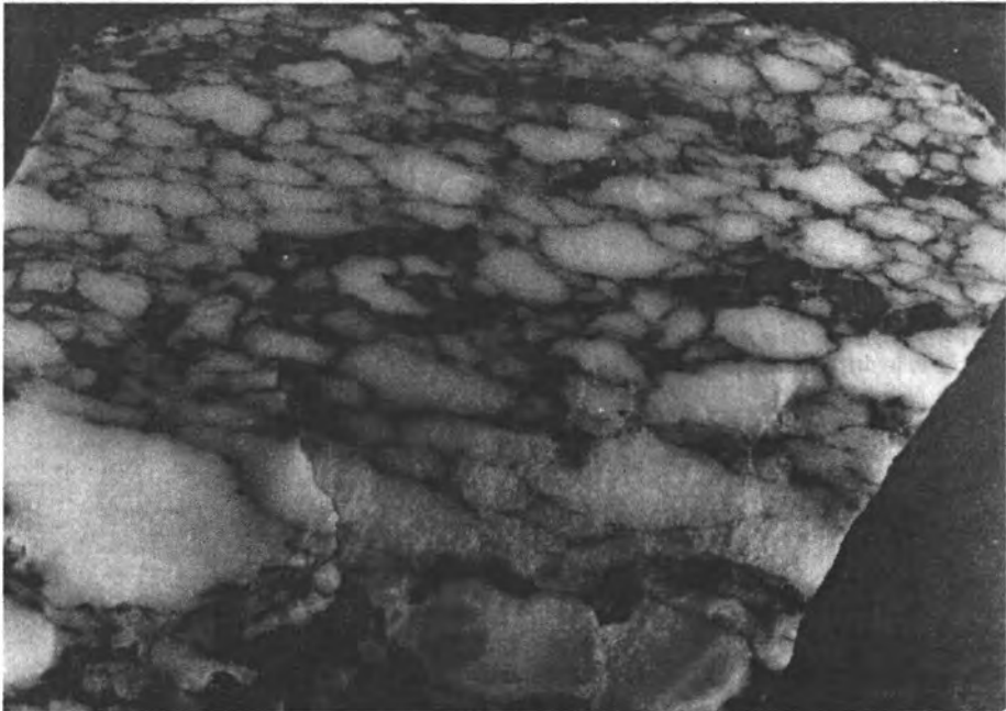
Abb. 3: Anschliff eines "chicken-wire"-Anhydrits in grauer Siltmatrix. Probe Sche 4, Bildbreite 13 cm.
