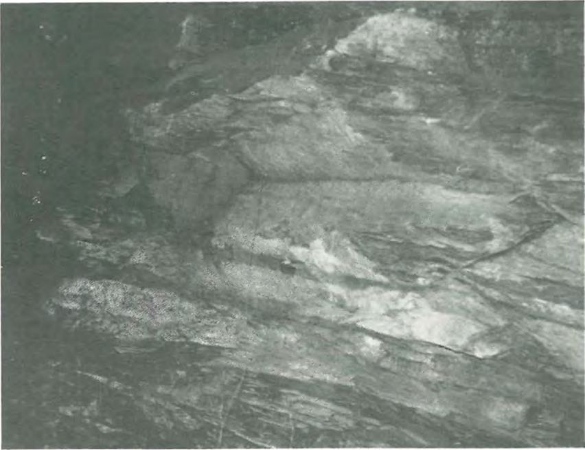
Abb. 12: Zerlegung des Gebirges durch Trennflächen in geometrisch wohldefinierte Teilkörper.
