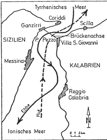
Abb. 4: Lage der Brückenachse sowie Flut- und Ebbestrom in der Messina-Straße. (Nach TOSCANO, 1980, verändert umgezeichnet.)
