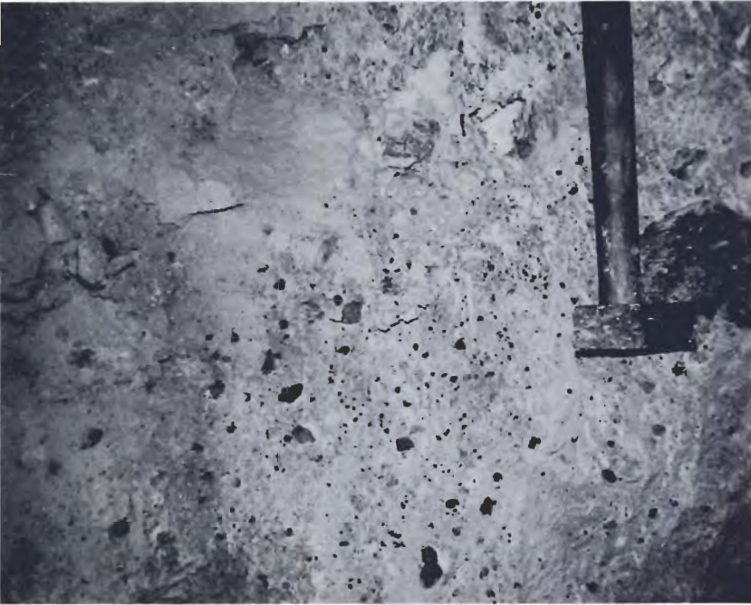
Fig. 1: Normal ausgebildetes Haselgebirge. In einer von dünnen Salz- und Gipsfäden durchzogenen Grundmasse (hell) sind gut gerundete Anhydritschollen (dunkel) eingebettet. Station N 176 m.
