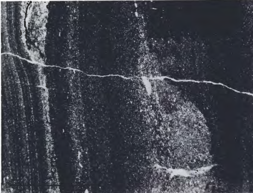
Fig. 1: „Bänderkalkserie“ im Hangenden des Annaberger Kalkes. Bosrucktunnel, Station N 1635 m, Probe A 135. Maßstabsleiste \hat{=} 1 cm.
