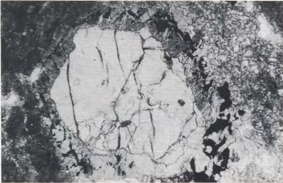
Abb. 12: Granat-Idioblast, umgeben von einem Kelyphitsaum aus Amphibol. Magnetit (schwarz) begrenzt den Saum nach außen. Kelyphitischer Eklogitamphibolit (Schliff Nr. 13194 ohne Analysator). Bildbreite 10 mm.
