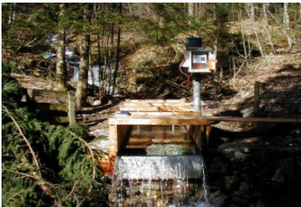
*Abbildung 4: Messgerinne zur Erfassung des Wasserstandes*
