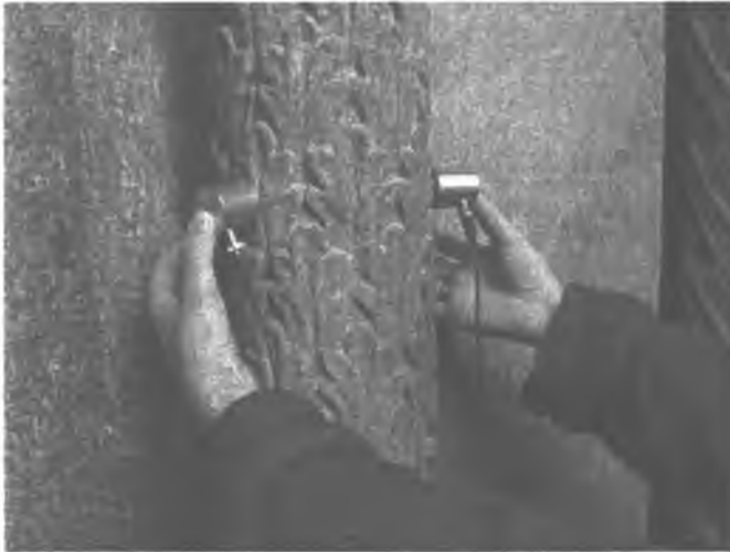
Abb.3: Ultraschallmessungen bei Nachsorgemessungen an romanischen Säulen des Riesentors aus Breitenbrunner Kalksandstein
