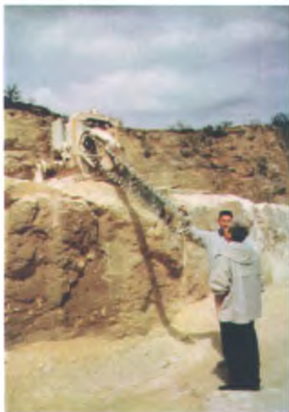
Abb. 10: Moderne Schrämmaschine im Steinbruch St. Margarethen.
