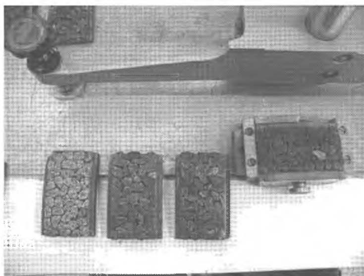
Abb. 40: Pendelgerät und Prüfkörper zur Bestimmung der Griffigkeit.
