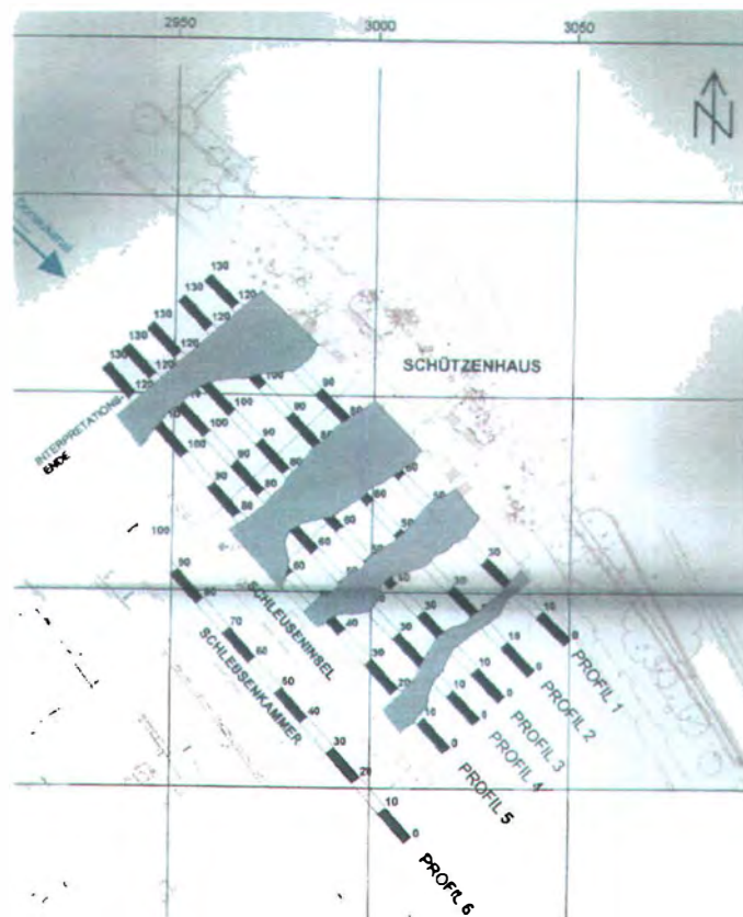
Abb.8: Profile der Donaukanalbefahrung mit dem Bodenradar
