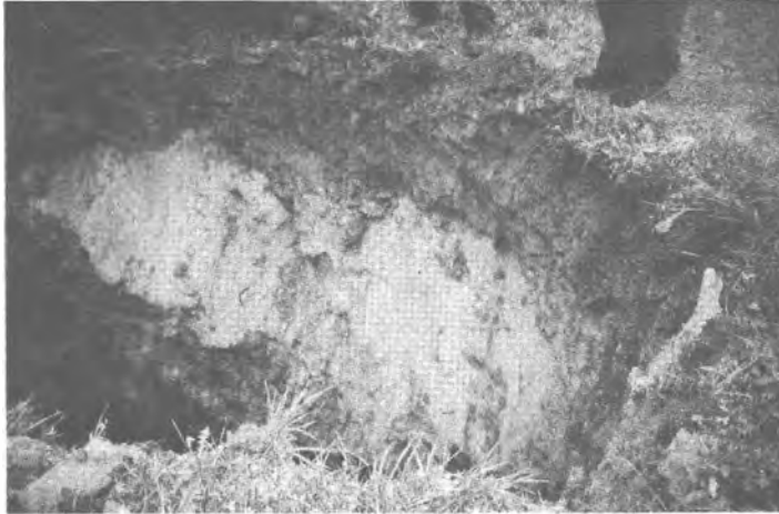
Abb. 2: Bewegungsfläche aufgrund von Hangkriechen
