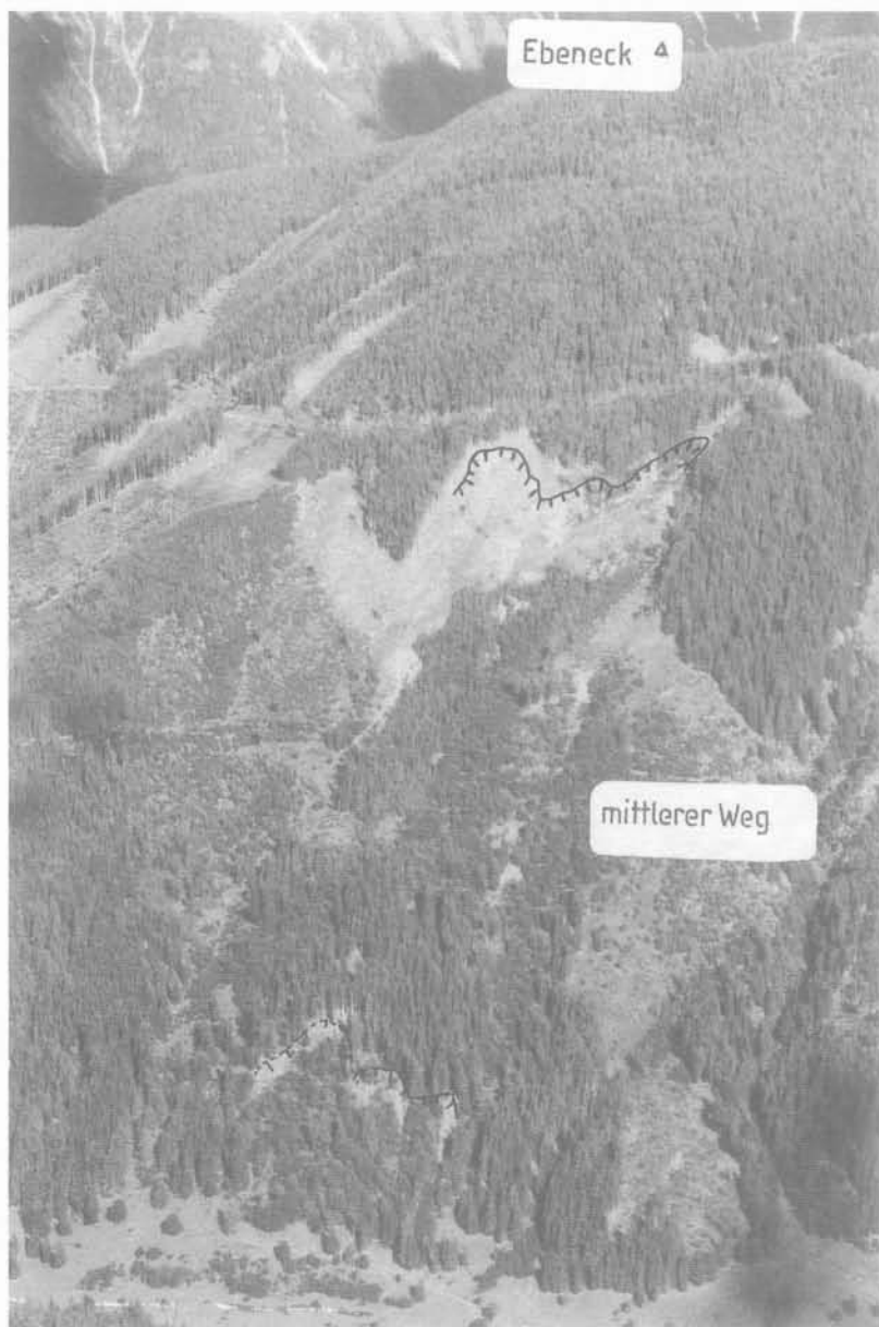
Abb. 2: Blick auf den instabilen Westhang im vorderen Kleinsölktal unterhalb des Ebeneck, von der gegenüberliegenden Talflanke (Greimelalm) aus betrachtet, Aufnahme Sommer 1995. Die langgestreckte Rutschung Kleinsölk (Bildmitte) begrenzen lateral und im oberen Abrißbereich aktive Erosionsherde (helle Areale). An der Rutschungsstirn markieren vegetationslose Bereiche den Abriß der Sekundärrutschung.
