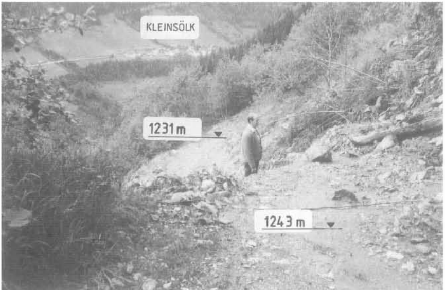
Abb. 8: Versetzung des "mittleren Weges" entlang der südlichen Scherzone um ca. 12 m, Aufnahme 1992. Im Hintergrund die Ortschaft Kleinsölk, auf der Verebnung einer Terrasse gelegen.
