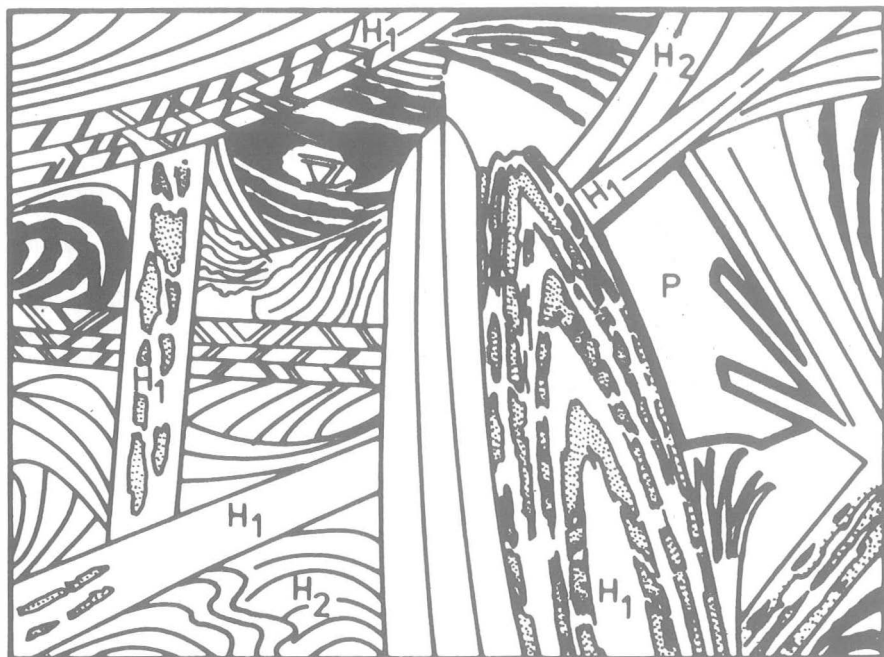
Abb. 4: Schematische Darstellung der Wachstumsgefüge im Erz von Pack/Stmk. (H 1 = früher Hämatit, H 2 = später Hämatit, P = Pyrit, punktiert = Magnetit, Schwarz = Lamellenzwischenräume, breiter bei flachem Schnitt).
