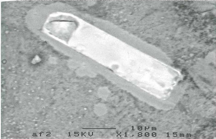
Abb. 7: Umgewandelter Pyroxenkrystal mit deutlichem Umwandlungssaum im Afwillit; Steinbruch Klöch, Nördlicher Bruch, Klöcher Klause, Steiermark, Österreich. REM: BSE-Bild. Bildbreite: 0,05 mm.
