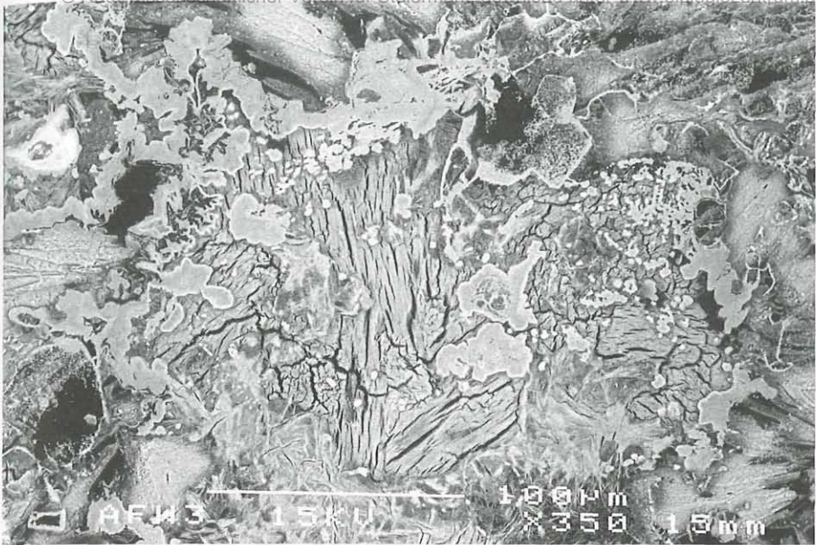
Abb. 9: Katoit in körnigen Aggregaten mit Ettringit/Thaumasit, Afwillit, Pyroxen und den röntgenamorphem Ca-Al-Si-Mineralphasen; Steinbruch Klöch, Nördlicher Bruch, Klöcher Klause, Steiermark, Österreich. REM: BSE-Bild. Bildbreite: 0,3 mm. Granular aggregates of katoite together with ettringite/thaumasite, awillite, pyroxene and röntgenamorphous Ca-Al-Si-minerals; basalt quarry Klöch, northern quarry, Klöcher Klause, Styria. BSE-image. Image width: 0,3 mm.
