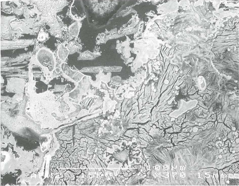
Abb. 2: Afwillit (Mitte oberer Bildrand) mit Ettringit/Thaumasit, Tobermorit, Tacharanit, Katoit und röntgenamorphen Ca-Al-Si-Mineralphasen; Steinbruch Klöch, Nördlicher Bruch, Klöcher Klause, Steiermark, Österreich. REM: BSE-Bild. Bildbreite: 0,3 mm. Afwillite (at upper middle) with ettringite/thaumasite, tobermorite, tacharanite, katoite and röntgenamorphous Ca-Al-Si-mineral phases; basalt quarry Klöch, northern quarry, Klöcher Klause, Styria. BSE-image. Image width: 0,3 mm.
