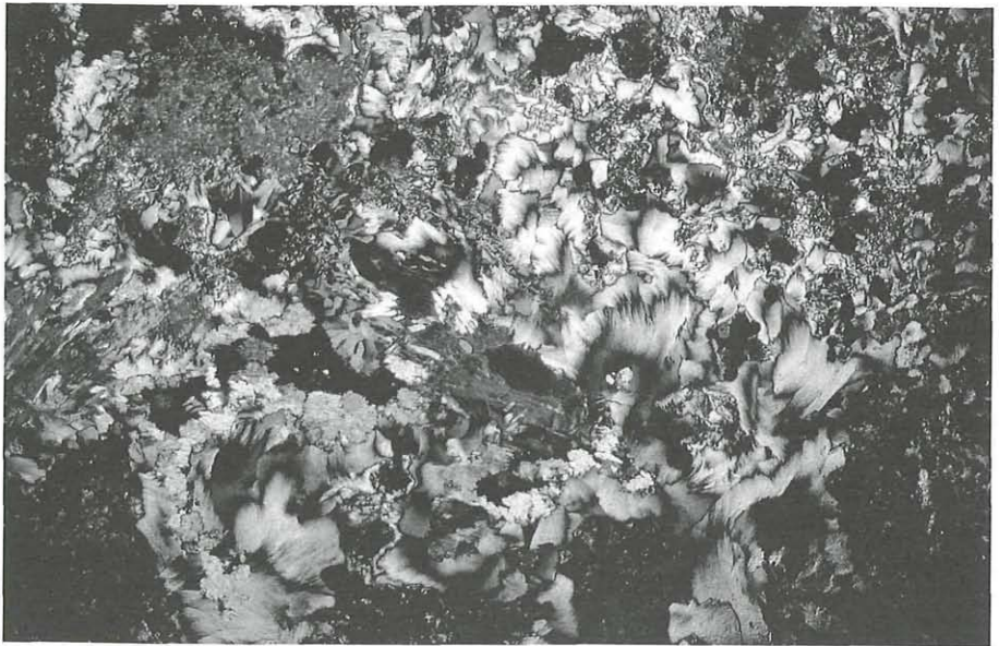
Abb. 4: Afwillit mit Tobermorit und Tacharanit; Steinbruch Klöch, Nördlicher Bruch, Klöcher Klause, Steiermark, Österreich. + Polarisatoren. Bildbreite: 2,5 mm. Afwillite met with tobermorite and tacharanite; basalt quarry Klöch, northern quarry, Klöcher Klause, Styria. Crossed polars. Image width: 2,5 mm.
