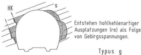
Abb. 2: Überprofiltypen im Gleinalm-Tunnel
