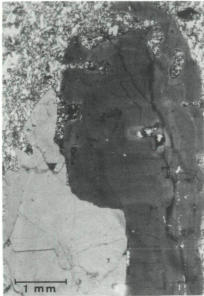
Abb. 1: Bohrung Gleichenberg 1981, Tiefe 320 m. Mikroskopisches Bild (gekreuzt polarisiertes Licht) eines Sanidin-Einsprenglings mit Or60, Karlsbader-Zwilling, Verwachsungsfläche generell (010), teilweise jedoch unregelmäßig. Zonare Wachstumsstreifung ist angedeutet. Massive magmatische Resorption bewirkt gerundete Oberflächen und reichliche Korrosionsschläuche.
