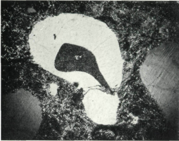
Abb. 1: Grünlichgrauer Porphyroid, Bruck an der Mur, nahe „Elisenruhe“. Typischer „Korrosionsquarz“ ( 1,46 \times 0,84 mm) mit eigenartig geformtem großen „Korrosionsschlauch“ im Innern des Kerns. Die in diesem enthaltene mikrogranitische Porphyrgrundmasse hat nur in der Mitte ganz wenig Serizit, ansonsten ist sie serizitfrei. Die erhebliche Serizitisierung der umgebenden Grundmasse kommt in der Abbildung deutlich zum Ausdruck. Im Bild links und rechts ebenfalls Quarzeinsprenglinge, mit BÖHMISCHER Streifung.
