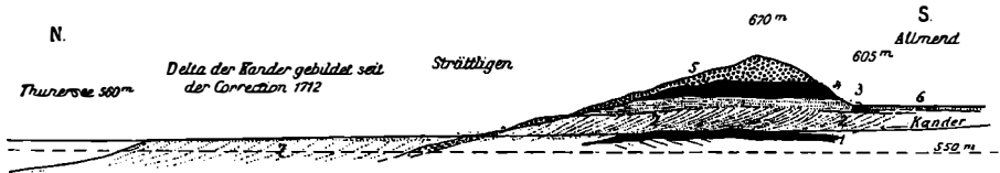
Fig. 71. Profil durch den Strättliger Hügel (Thunersee) im durch die Korrektur der Kander seit 1712 erzeugten Erosionsdurchschnitt. — Unterlage Triaskalk und Gips in diesem Schnitte nicht entblößt. Dann:
