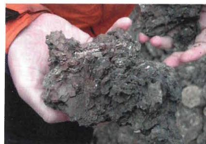
Die plastischen Buntmergel im Gschlifgraben sind – vor allem in Kombination mit Wasser – wie ein Schmiermittel.
