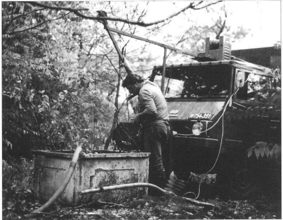
Abb. 2. Kurzpumpversuch bei einem Brunnen mit Entnahme von Wasserproben für Isotopenbestimmungen. Apetlon, Paulhof, Brunnen 123.
