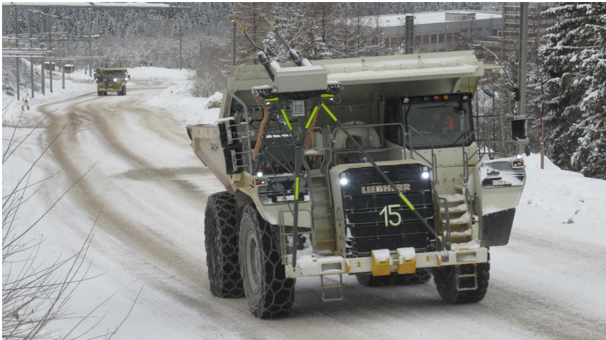
Abbildung 1 Elektrische SLKWs im Trolley-Winterbetrieb der VA Erzberg GmbH
