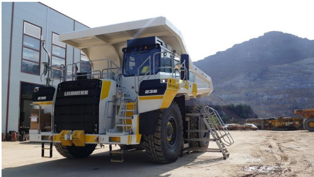
Abbildung 2: VA Erzberg GmbH – Liebherr T236; Testbetrieb des diesel-elektrischen angetriebenen Liebherr T236 mit einer Nutzlast von 100 t
