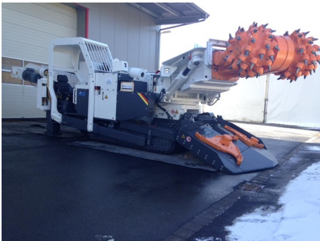
Abbildung 5: Salinen Austria AG – Teilschnittmaschine
