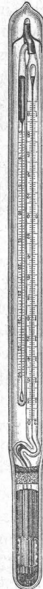
Fig. 3. Umkippthermometer von C. Richter in der Stellung beim Hinunterlassen; die Abreißstelle ist durch den Kork verdeckt (Klischee von C. Richter, Berlin)
