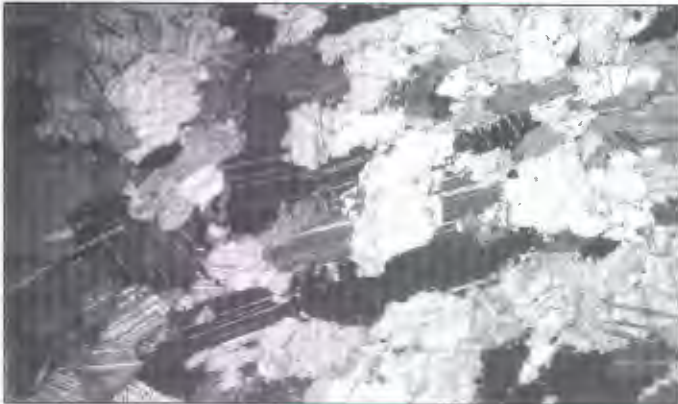
Abb. 7 Kalzitkristalle im Nebengestein, ausgeprägte Druckzwillingslamellierung (Meixner Sammlung, Probe HS 15 Vergr. 36fach, Nicols X).
