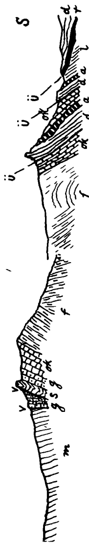
Abb. 21. Profil von Nesselwang zum Vilstal (nach Ampferer und Reiser). Molasse, Kreide und Flysch durch Verwerfungen getrennt, rechts die in mehrere Teile getrennte Allgäuer Schubmasse. m Molasse, f Flysch, ok obere Kreide, g Gaultsandstein, s Schrattenkalk, a oberer Jura, d Hauptdolomit, r Rauchwacken der Raibler Schichten, ü Überschiebungen, v Verwerfung.
