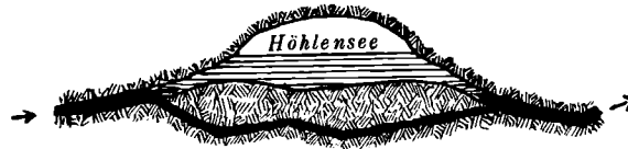
Abb. 48. Längsschnitt durch einen Höhlensee, der von einer Druckströmung in der Tiefe sozusagen getragen wird, indem Druckstollen sowohl den Zufluß als auch den Abfluß besorgen.
