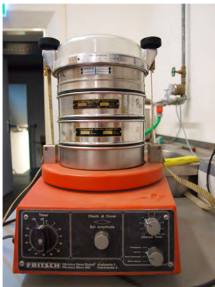
Abb. 8: Die verwendete Vibrations-Siebmaschine Analysette 3 mit drei Analysesieben.
