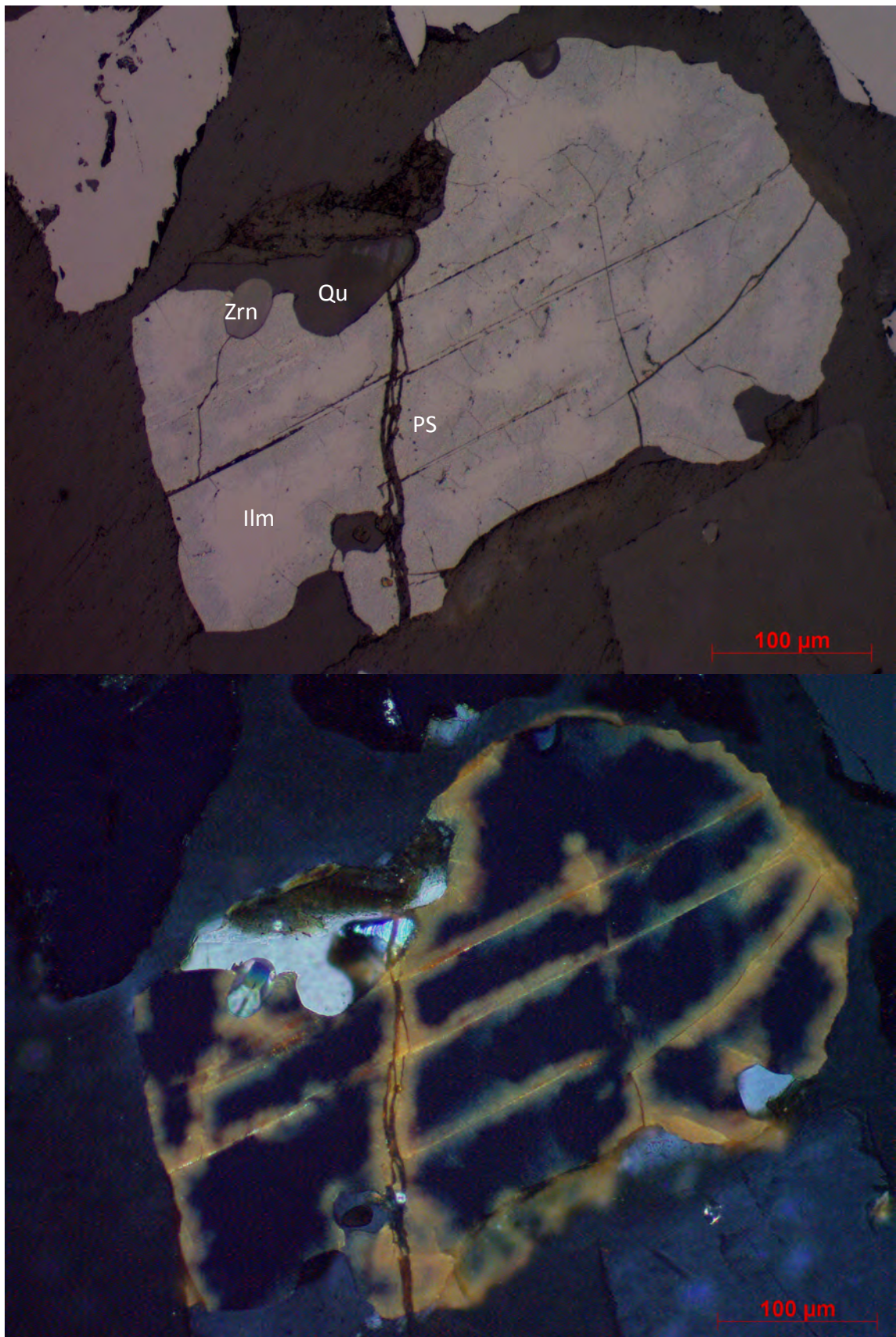
Abb. 15: Ilmenitkorn mit drei Titan-Phasen: Nicht alterierter Ilmenit (//N, Bild oben, braungrau, Ilm) mit Umwandlung in Pseudorutil entlang von Rissen (//N, Bild oben, grau-blau, PS) und in Leucocoxen in den Rissen (+N, Bild unten, gelblich). Einschluss von Zirkon (Zrn) und Verwachsung mit Quarz (Qu). (20fache Vergrößerung, oben //N, unten +N, Probe 03)
