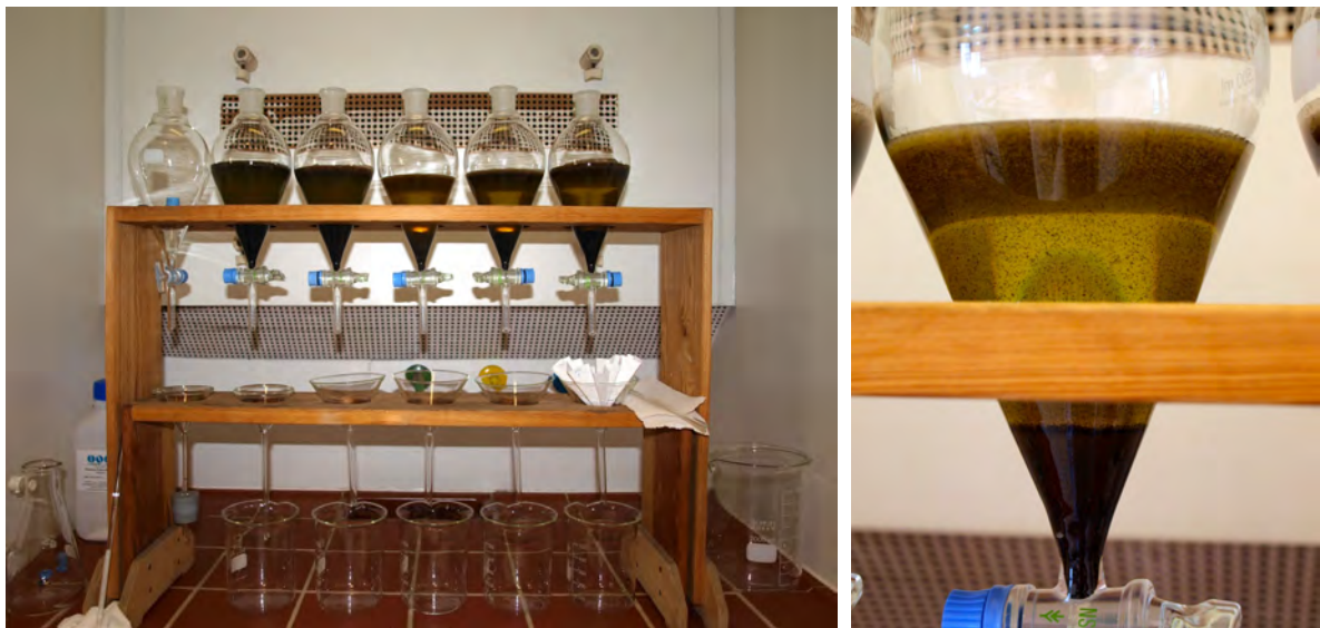
Abb. 9: Geräteaufbau für die Schweretrennung mittels Polywolframat, im rechten Bild ist das bereits erfolgte Absinken der Schwerefraktion im Scheidetrichter gut erkennbar.
