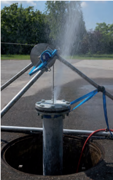
Abb. 5-2: Temperaturlogging in der Bohrung Ravensburg GB1. Links: Schleuse zur Verminderung des artesischen Wasseraustritts und Dreibein zur Kabelführung der Temperatur-Messsonde bei laufender Messung. Gut sichtbar ist der Wasseraustritt rund um die Kabeldurchführung am Schleusenkopf. Rechts: Messaufbau.
