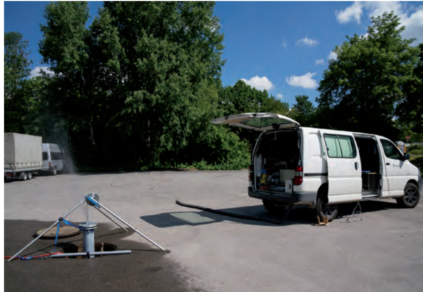
Abb. 5-2: Temperaturlogging in der Bohrung Ravensburg GB1. Links: Schleuse zur Verminderung des artesischen Wasseraustritts und Dreibein zur Kabelführung der Temperatur-Messsonde bei laufender Messung. Gut sichtbar ist der Wasseraustritt rund um die Kabeldurchführung am Schleusenkopf. Rechts: Messaufbau.
