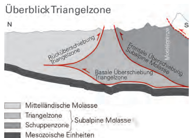
Abb. 3-2: Schematische Übersicht zur tektonischen Situation im Bereich der Subalpinen Molasse in der Schweiz. Die Schuppenzone zwischen alpinen Decken und Triangelzone i. e. S. dünnt gegen Nordosten aus, weshalb beide Bereiche in Deutschland traditionell als Faltenmolasse zusammengefasst werden. Als Aufgerichtete Molasse werden dabei die nach Norden verkippten Molasseschichten unmittelbar nördlich der Rücküberschiebung bezeichnet.
