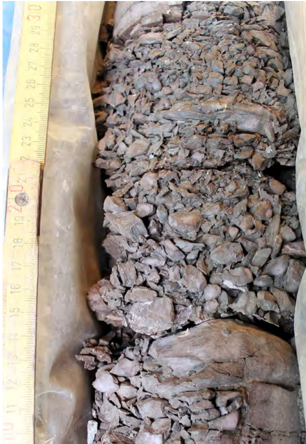
Abb. 11: Lithotypen Einheit D (KM 13); LE 209 zerfallender Tonstein, typisches Erscheinungsbild der Kernstrecke 13; Maßstab in cm (Foto: U. GEBHARDT).
