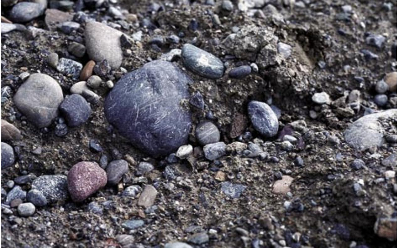
Abb. 7: Moränensediment an der Einschnittsböschung der Bundesautobahn A 96 bei Neuravensburg mit „gekritzten“ Geschieben. Durchmesser des größten Geschiebes 10 cm
