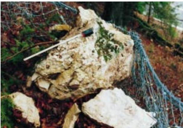
Abb. 43: Abgestürzte Felsblöcke im Schutznetz oberhalb L 277 im Donautal
