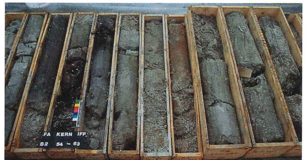
Abb. 26: Zur Untersuchung der Kiessande des Oberrheingrabens werden Bohrungen bis zur Kiesbasis niedergebracht.
