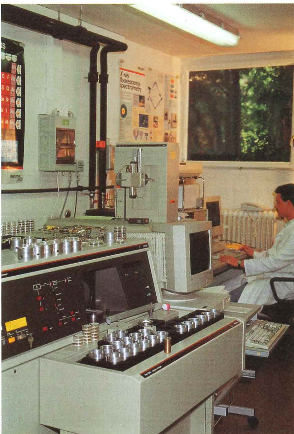
Abb. 24: Röntgenfluoreszenz- und Diffraktometrielabor zur Untersuchung von Festgesteinsproben
