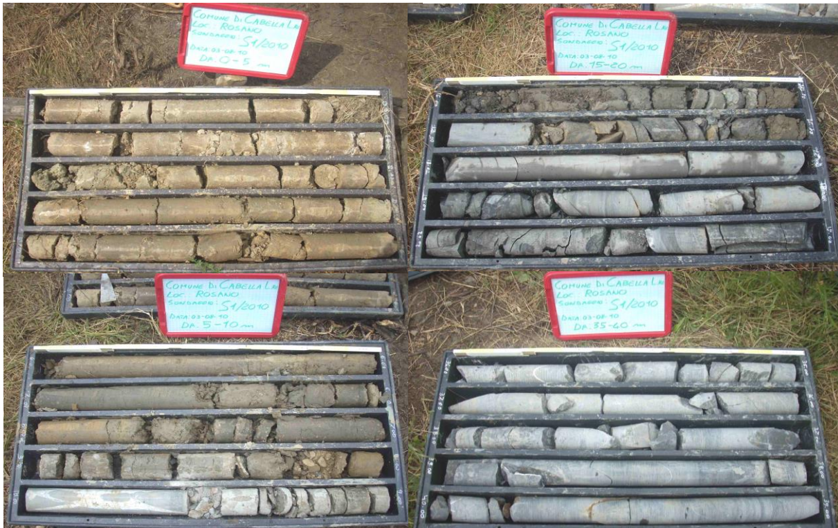
Abb. 46: Teile des Aufschlusses der Kernbohrung S1 (links: 0-10 m unter GOK; rechts oben: 15-20 m unter GOK; rechts unten: 35-40 m unter GOK) in welcher der Inklinometer eingebaut war
