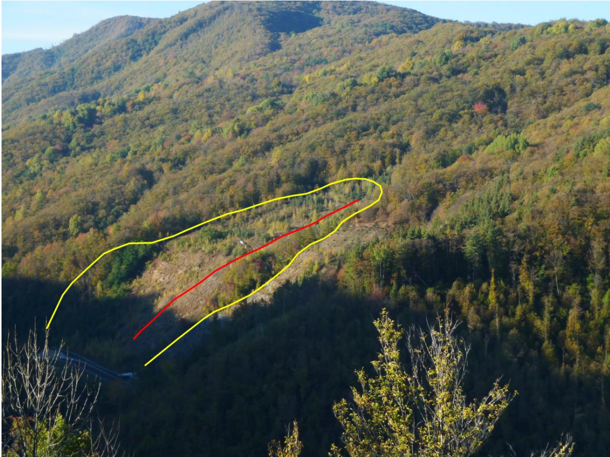
Abb. 37: Lage des geoelektrischen Monitoring Profils in Bagnaschino (rote Linie) innerhalb des aktiven Rutschbereich (gelbe Linie) - Ansicht von gegenüberliegender Talseite
