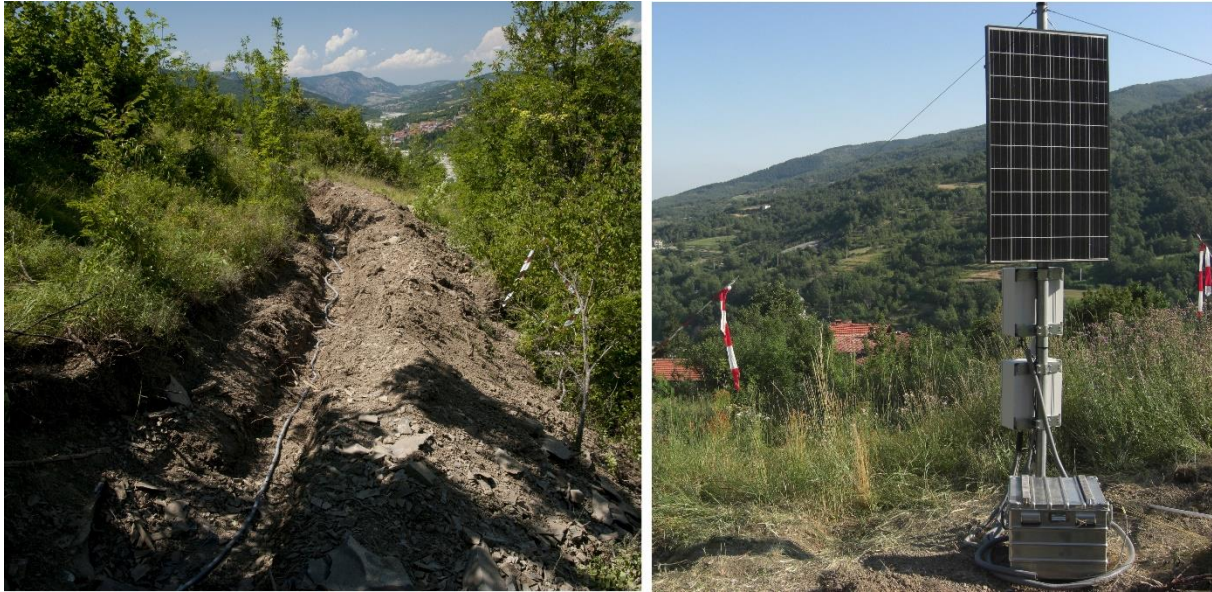
Abb. 43 Aufbau des geoelektrischen Monitoring Profils in Rosano (links), Geomon4D Messsystem (rechts)
