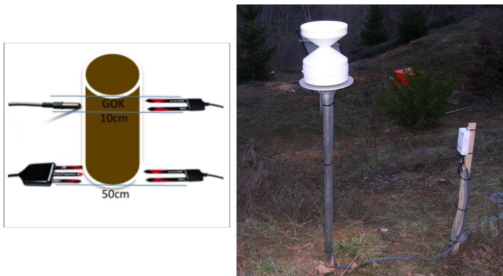
Abb. 8: Symbolhafter Einbau der Bodensensoren (links) und aufgebauter Decagon Datenlogger mit Niederschlagsmesser an einer LAMOND-Monitoring Site (rechts)
