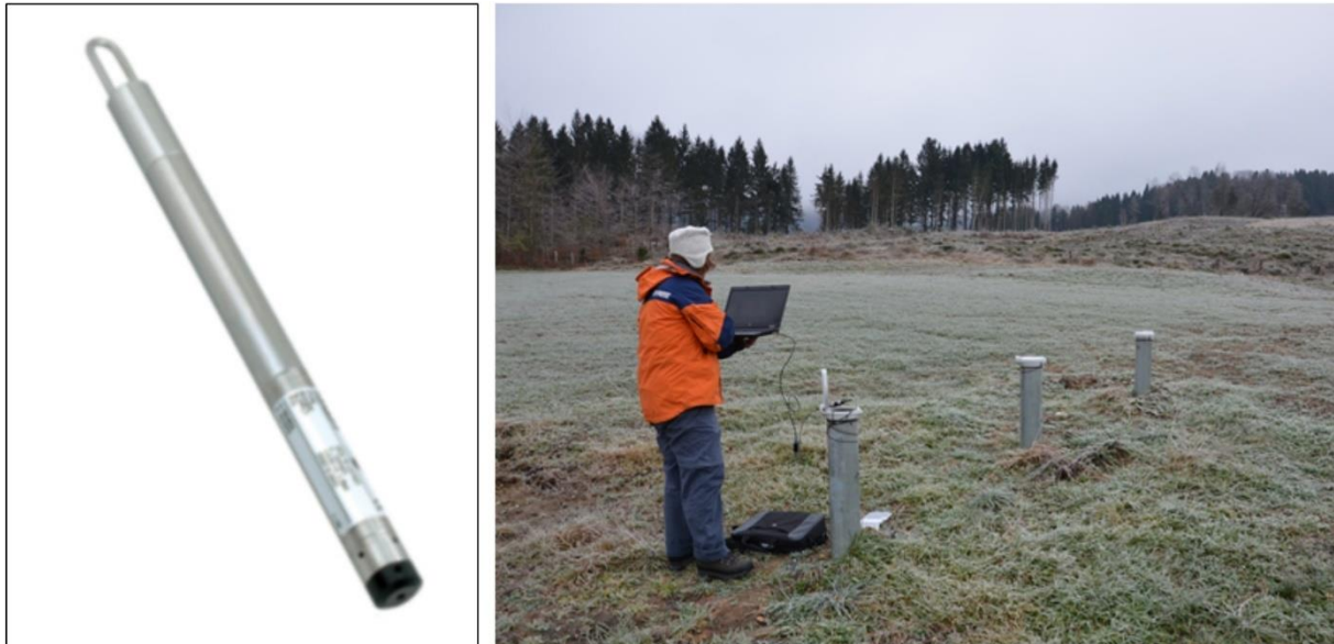
Abb. 7: Piezometer Typ DCX-16 (links), Auslesen der Daten im Feld (rechts)
