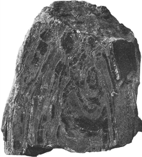
Fig. 69. Itabirit von Krivoi Rog, bestehend aus abwechselnden Lagen von Quarzit (hell) und Roteisen (dunkel).
