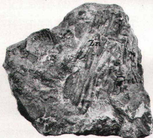
Fig. 27. Handstück aus der Haupterzzone. — Zinkblende. — Stalaktiten.
