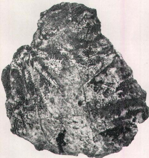
Fig. 41. Handstück aus dem Haupterzzug; Westkluftsystem. Kristallskelette von Bleiglanz, sogenanntes Schrifterz.
