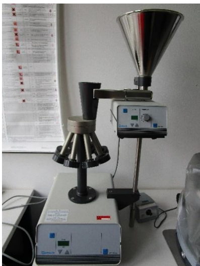
Abbildung 8: Der elektronische Sedimentteiler, mit dem die Proben pro Durchgang auf ein gleichmäßig aufgeteiltes Achtel reduziert werden konnten.
