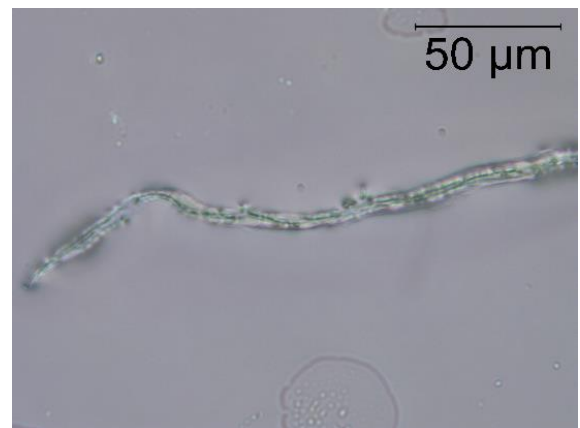
Abbildung 31: Eine 200 Mikrometer lange Plastikfaser aus Streupräparat 5B; mit dem Durchlichtmikroskop betrachtet.
