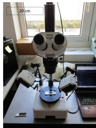
Abbildung 9: Ein Binokular mit montiertem Kamerasystem, mit dem die Fotos der Proben in den Sammelzellen gemacht wurden.
