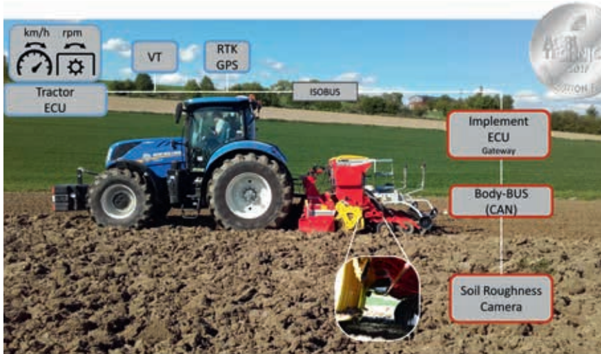
Digitale Hilfe bei der Bodenbearbeitung: Drehzahl und/oder Fahrgeschwindigkeit werden automatisch geregelt.
