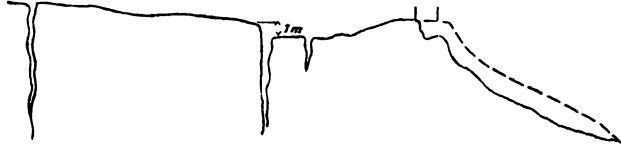
Fig. 5. Spalten im Rothschildgarten und Abbruch des Schulweges.
