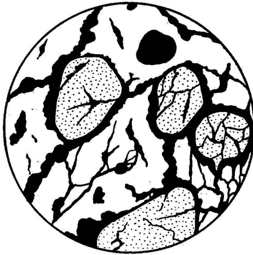
Fig. 33. Dünnschliffbild des quarzigen Deckengesteines der Eisenerz- lagerstätte von Krivaja.
