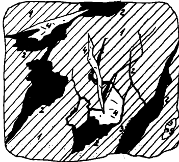
Fig. 16. Erzstück vom alten Tomruči-Erbstollen. 1 = Siderit. 2 = Galenit. 3 = Pyrit. 4 = Quarz. 5 = Cerussit. \frac{1}{2} natürliche Größe.
