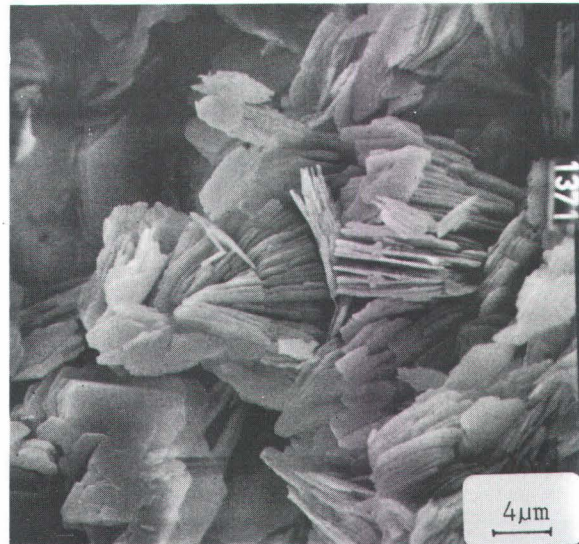
Podbořany (Krásný Dvůr) deposit, 1.3.2. Fig. 2: Stacks of idiomorphic pseudo-hexagonal kaolinite plates (kaolin K).
