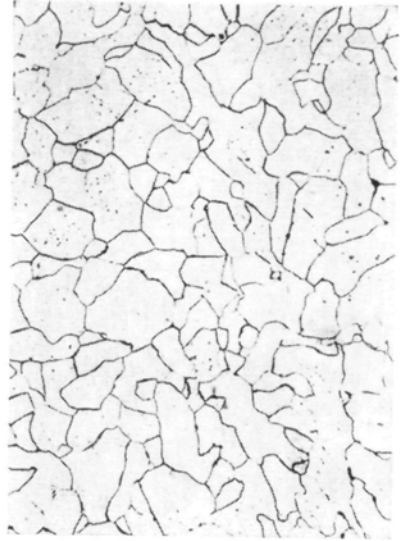
Bild 4: Römisches Eisenmesser, ferritische Grundmasse. Ätzung: Alkoholische Salpetersäure. Vergrößerung: 70fach.
