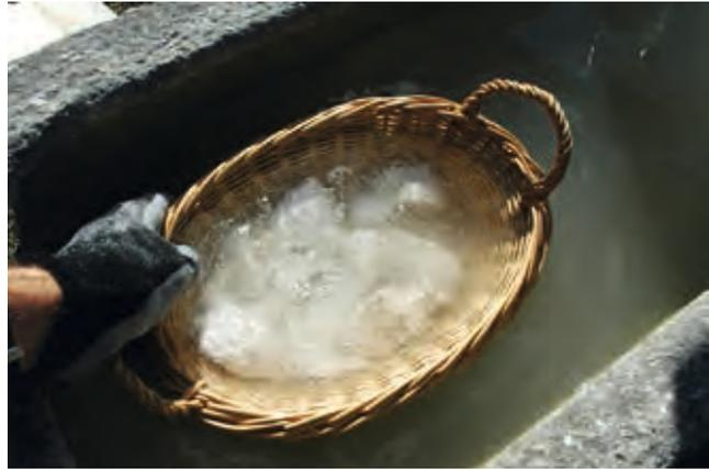
Abbildung 3: Zerschlagen des Branntkalks<sup>22</sup>    Abbildung 4: Eintauchen des Branntkalks<sup>23</sup>
