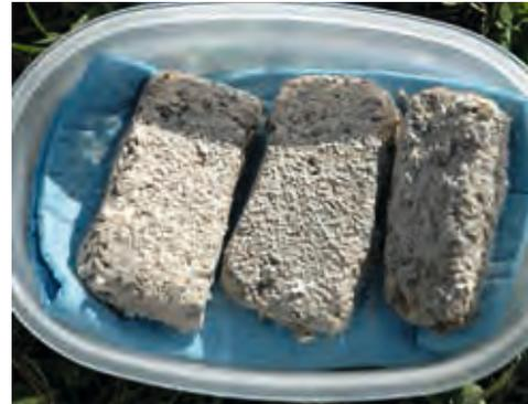
Abbildung 8: Probekörper korbgeleschter Mörtel<sup>28</sup>
