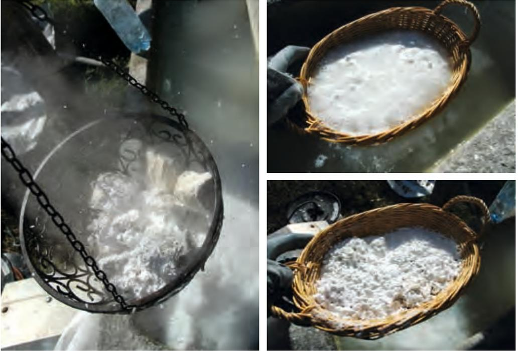
Abbildung 5: Zerplatzen des Kalks<sup>27</sup>
